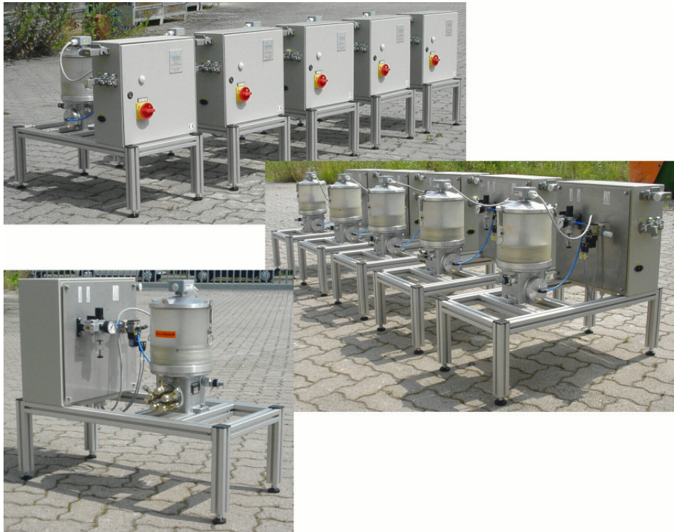
Dosiereinheiten mit Vorratsbehälter, Pumpe und Steuerung.
